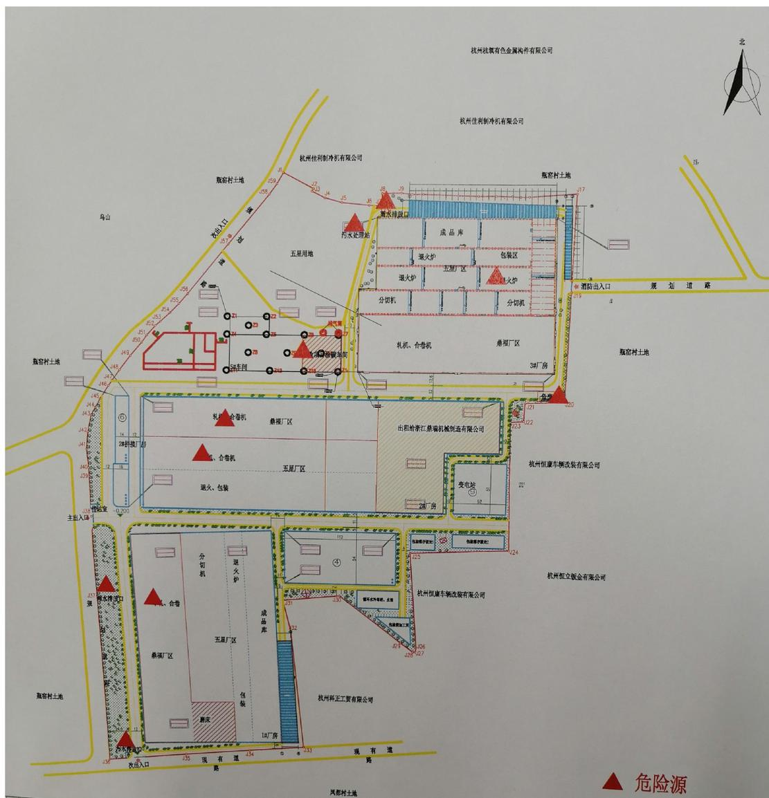
附图 4 厂区雨污管网及应急系统示意图
